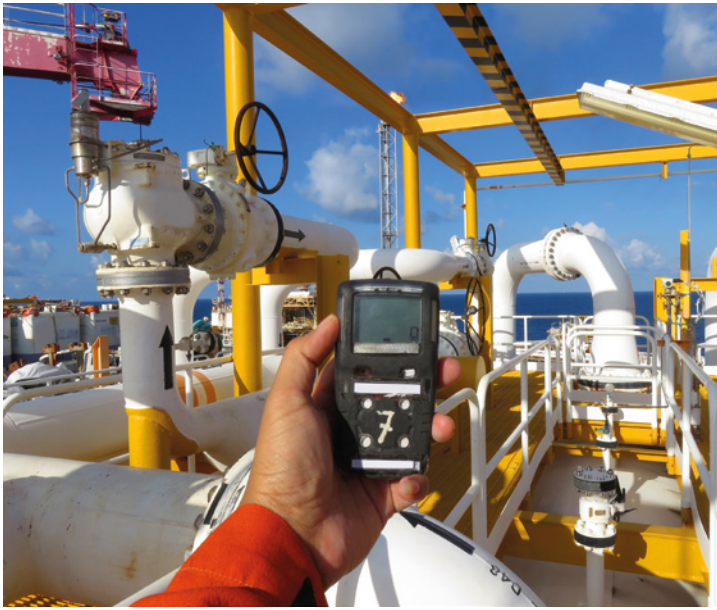
Bild 2: Gasdetektor: Flüchtige Emissionen von H_2 sind für den Menschen nicht wahrnehmbar
